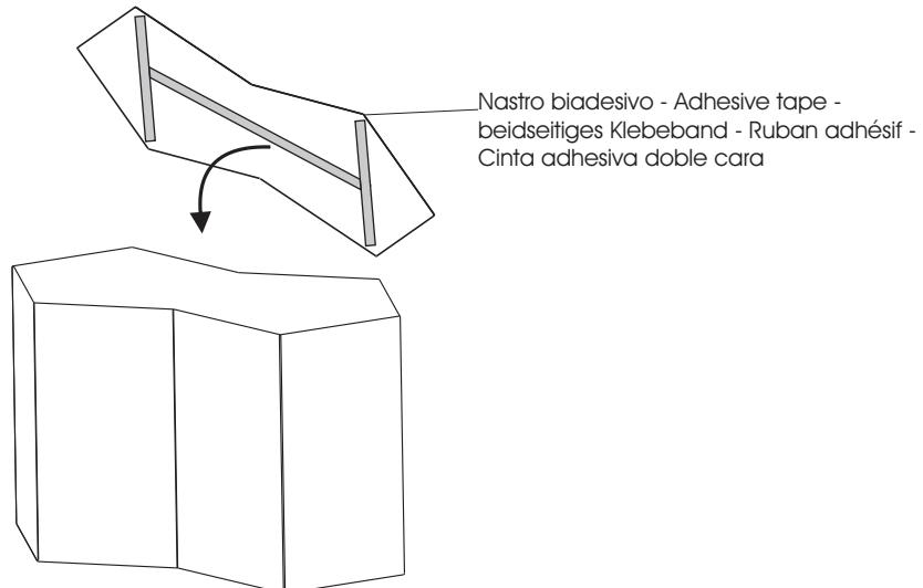
**Montaggio ripiani inferiori / Lower tops assembling / Aufbau der unteren Platte / Montage plateaux inférieurs / Montaje sobre inferior**
