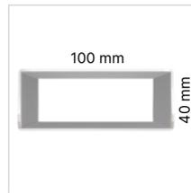
Longoni realizzati in acciaio a sezione rettangolare 100x40 mm, sp. 1.5 mm, verniciati a polveri epossidiche.
