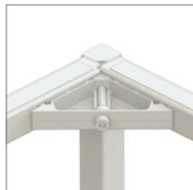
Traversi e longoni a sezione quadrata 30×30mm, sp. 2 mm. Giunto in zama, fissaggio con una sola vite.
