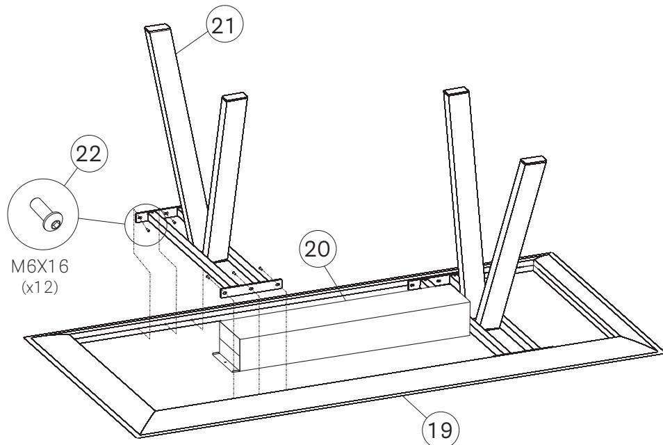
**FR** - Emboîter les pieds (21) dans le passe-câble (20) et les fixer à la structure (19) à l'aide des vis (22).
