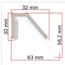
Gamba in profilato di lamiera di acciaio decapato. Sezione iniziale 30×32mm (finale 63×56,2mm), sp. 4 mm.
