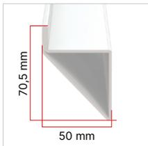
Traverso gamba in tubo profilato decapato, sezione 50×70,5 mm, sp. 2 mm con saldati innesti a scomparsa per inserimento travi.
