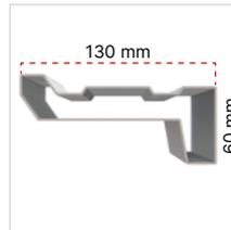
Telaio perimetrale in profilato di lamiera di acciaio spessore 1,5 mm, a sezione 130x60 mm.
