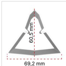
Gamba in profilato di lamiera di acciaio spessore 2 mm, a sezione 60,5x69,2 mm.
