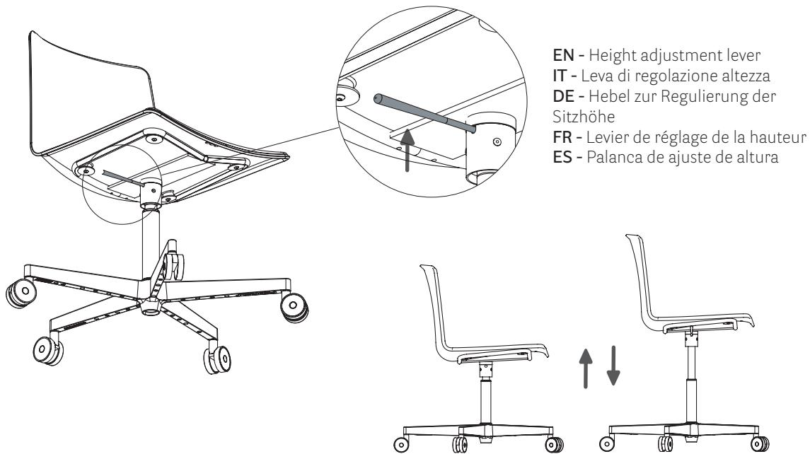
**EN - Height adjustment lever****IT - Leva di regolazione altezza****DE - Hebel zur Regulierung der Sitzhöhe****FR - Levier de réglage de la hauteur****ES - Palanca de ajuste de altura**
