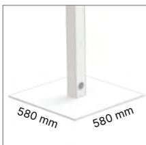
Basamento di dimensioni 580×580 mm, in lamiera di acciaio sp. 8 mm verniciata a polveri epossidiche, con copertina superiore di protezione in lamiera di acciaio inox satinato sp. 0,8 mm.
